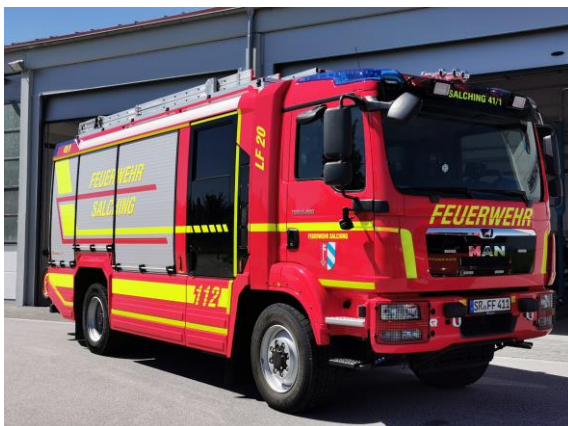
MAN TGM 13.290 mit Rosenbauer-Aufbau Löschgruppenfahrzeug LF 20 2.500 Liter Wassertank, 120 Liter Schaumtank Funkrufname: Florian Salching 41/1 Übergabe: 2019
